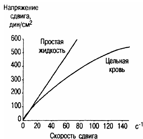
Рис. 23.1. Вязкость как коэффициент пропорциональности между напряжением и скоростью сдвига.
