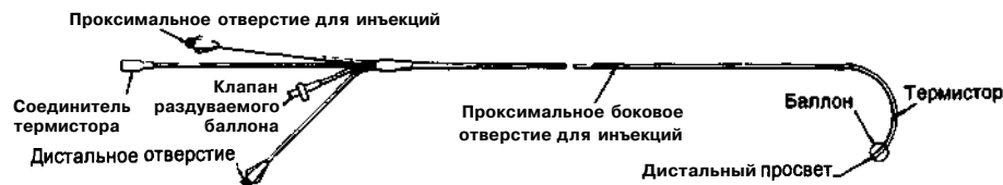
Рис. 20.16. Схематическое изображение катетера для легочной артерии.
