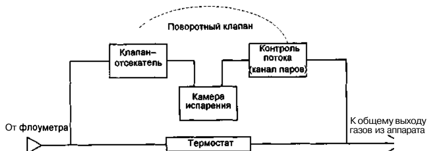
Рис. 16.б,б. Схема испарителя Mark 5 TEC
