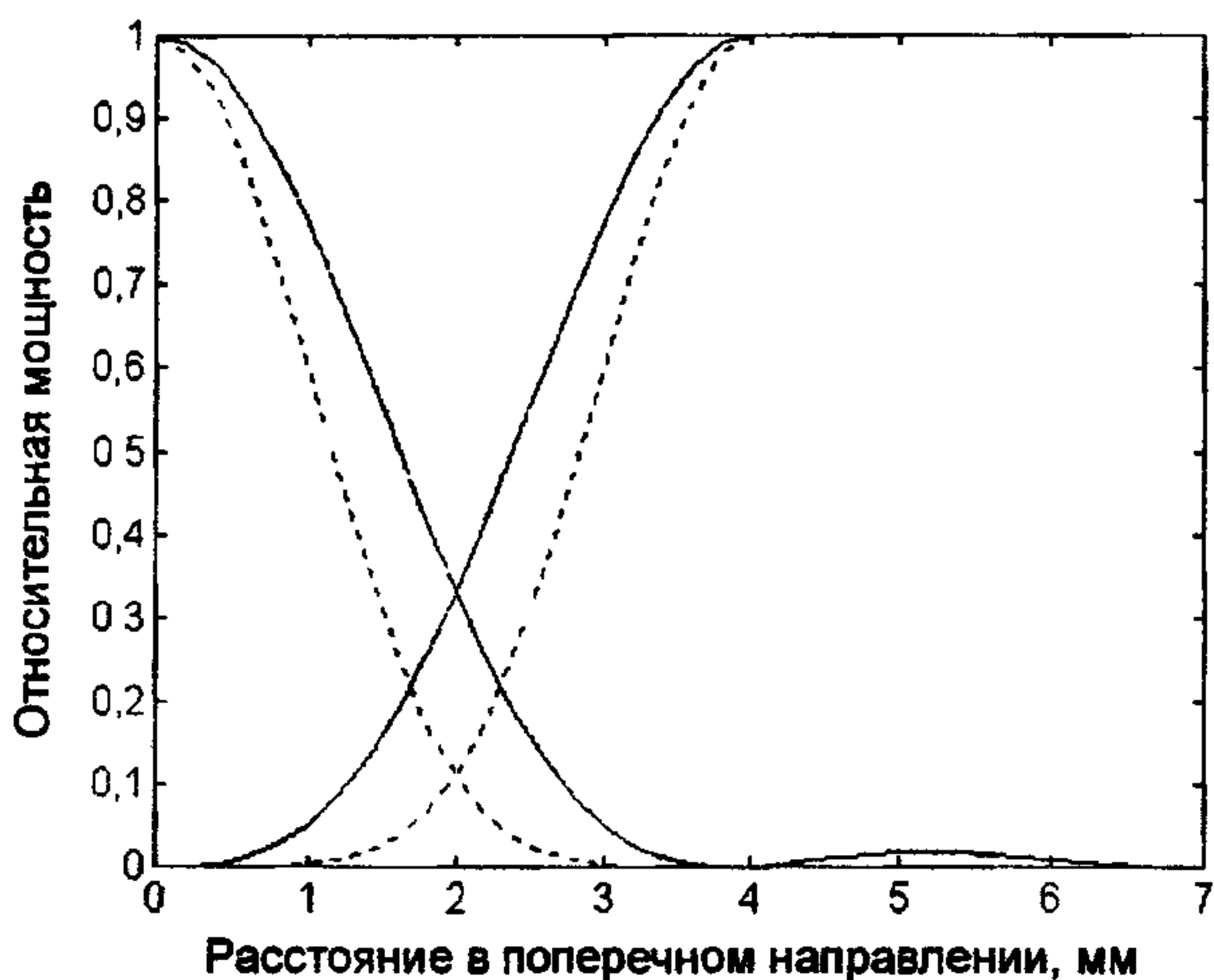
Рис 4.4. Применение критерия Рэля с использованием диаграмм Эйри: — — для случая двух самосветящихся точечных источников. — — — для задачи активной УЗ эхо-локации
